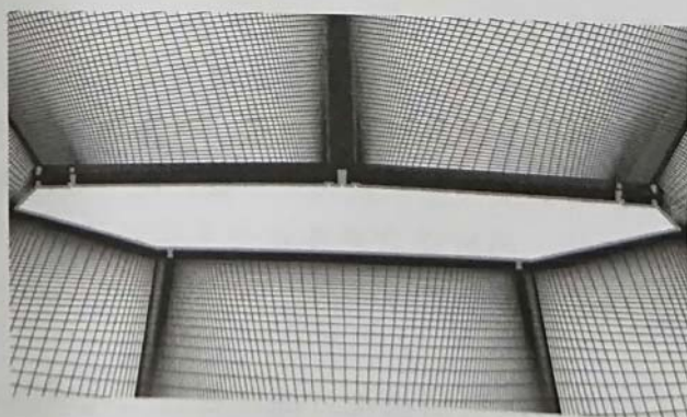
图 D-3 断面流场网格划分示意图
